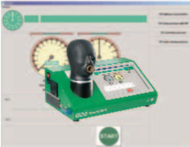
SmartCHECK es la próxima generación de banco de pruebas compacto y totalmente automático para cualquier equipo ERA del mercado. Una cabeza de pruebas de nuevo diseño asegura el fácil manejo y un ajuste hermético de las máscaras. Se caracteriza por incorporar un sistema de ordenador con pantalla táctil.
